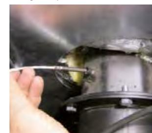
Sonda de temperatura de gases de com-bustión.
